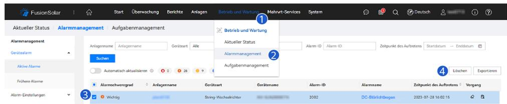
Wechseln Sie zum Eigentümerkonto mit Berechtigung für das PV-Anlagenmanagement. Klicken Sie auf der Startseite auf den Namen der PV-Anlage, um die Seite der PV-Anlage aufzurufen und klicken Sie nach Aufforderung auf **Bestätigen**, um den Alarm zu löschen.
