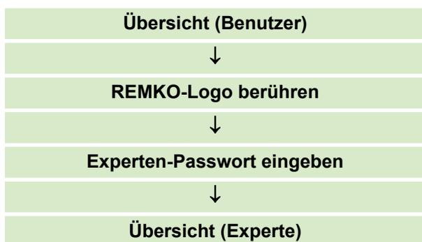
In der Expertenebene gelangen Sie zum Parameter "Wärmepumpe" wie folgt:
