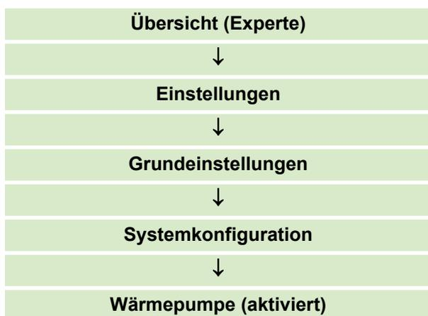
Deaktivieren Sie dann die Wärmepumpe in dem Sie den Parameter "Wärmepumpe" berühren und über die Anzeige "V und Λ" von "aktiviert" auf "deaktiviert" ändern.
