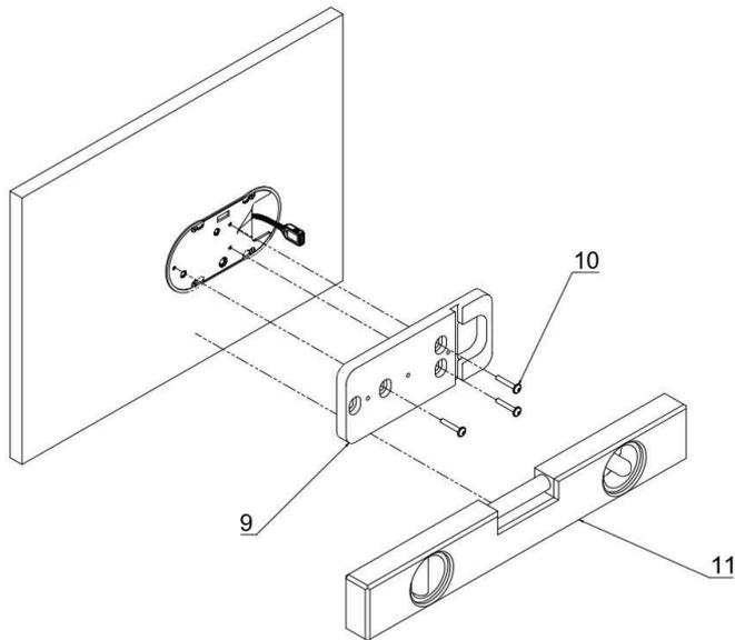
**1** Diese Anleitung zeigt die Montage mit Unterputzdose. Das free wird hier exemplarisch im Querformat montiert.
