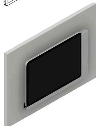
**3** Befestigen Sie das free mit den beigelegten Schrauben (6) (Senkschraube 10 mm) an der Abstandsplatte.
