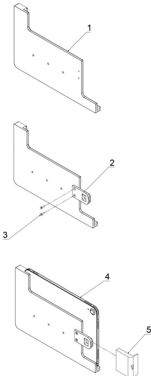
**1** Demontieren Sie das free (1) (vgl. hierzu die Produktanleitung free, Kapitel Montage free, Seite 15, Schritt 4).
