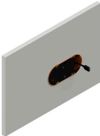
**7** Jetzt kann das Montageblech wieder eingesetzt und mit den vier Schrauben (8) gut befestigt werden.
