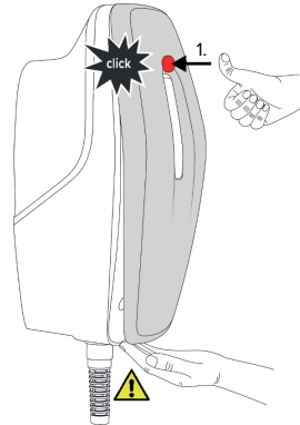
sl. 18: Namestitev sprednjega pokrova – 1
