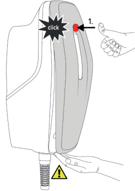
Kuva 18: Front Coverin kiinnitys – 1
