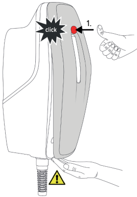
Fig. 18: Colocación de la cubierta frontal - 1
