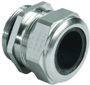
AGRO Kabelversch. PROGRESS MS M85x2 Kabelklemmbereich 63.0 - 70.0 mm
