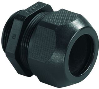
AGRO Kabelversch. SYNTEC PA6 M12 schwarz RAL9005 Ø 2,5 - 6,5mm (UL 5-6.5)
