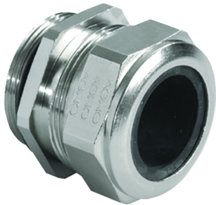
AGRO Kabelversch. PROGRESS MS M32 Kabel Ø 17.0-21.0mm (UL 19.3-21.0)
