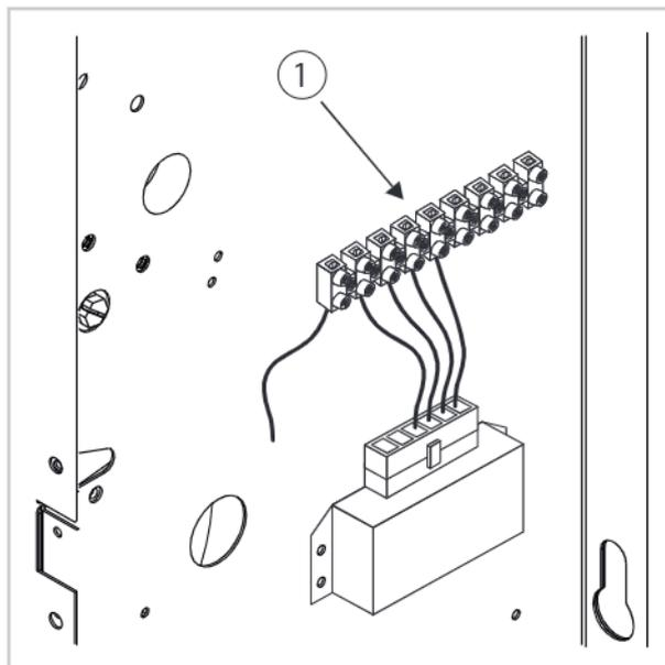
Abb. 16: Elektrischer Anschluss
