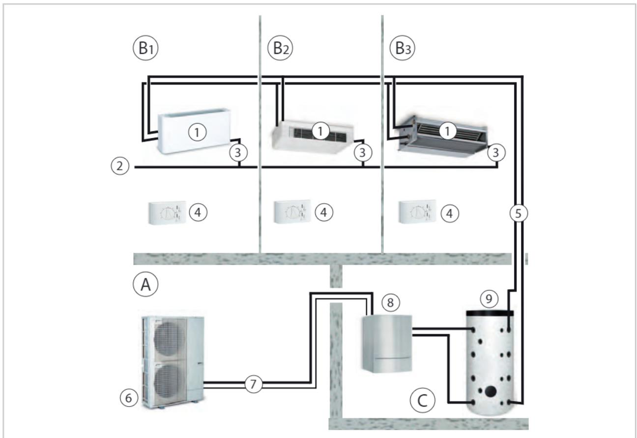
Abb. 4: Beispiel Systemaufbau 2-Leiter-System (Wärmepumpen-System)
