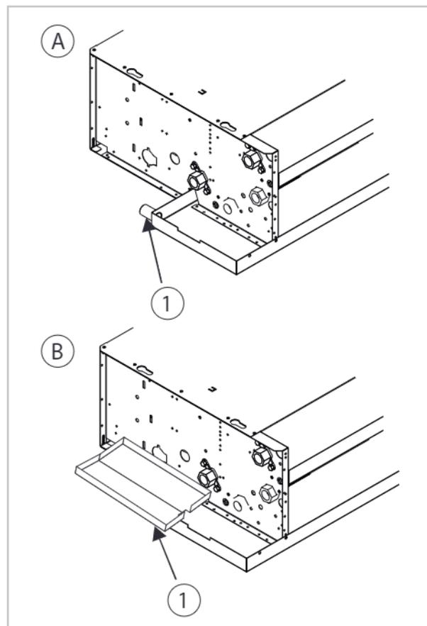
Abb. 15: Kondensatanschluss
