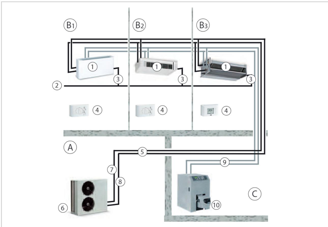
Abb. 5: Beispiel Systemaufbau 4-Leiter-System (Kaltwasser-Klimasystem)
