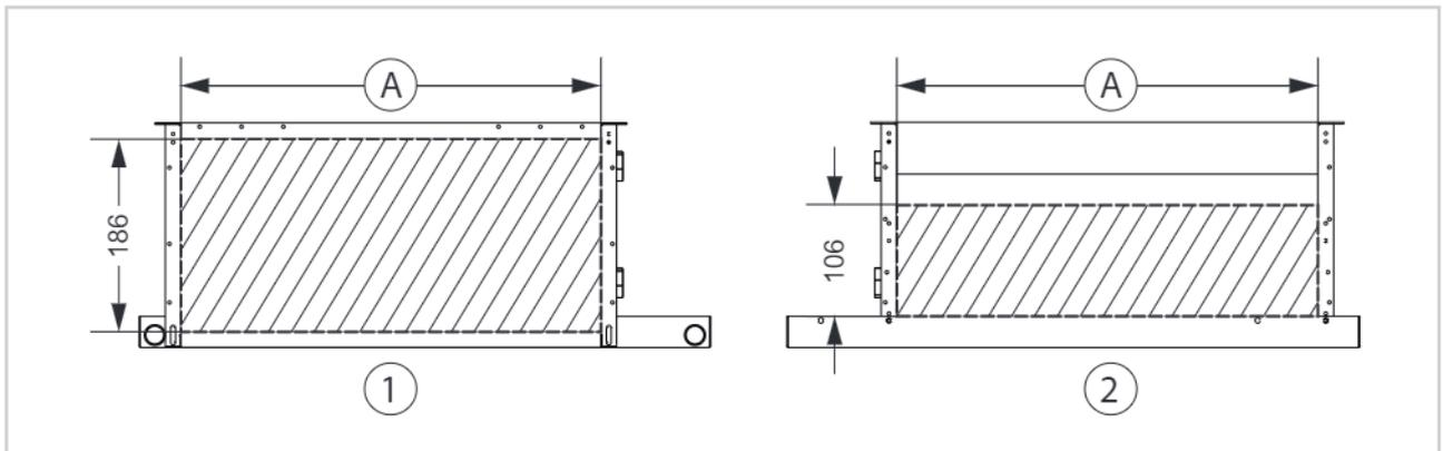
Abb. 13: Abmessungen Kanalanschlüsse
