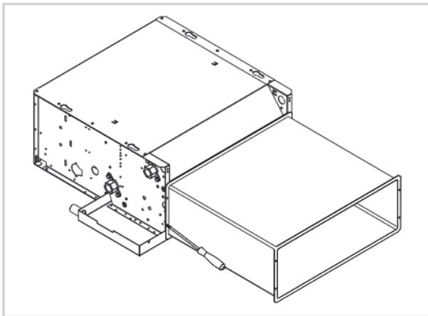
Abb. 14: Montage von Kanalkomponenten
