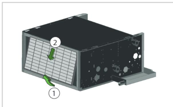
Abb. 18: Filterentnahme
