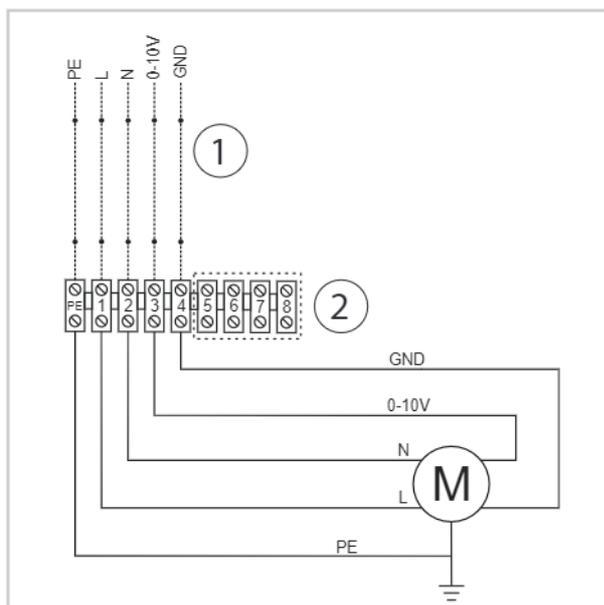
Abb. 17: Elektrisches Schaltschema
