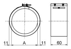
Darstellung im eingebauten Zustand, Lieferung erfolgt in gestreckter Form
