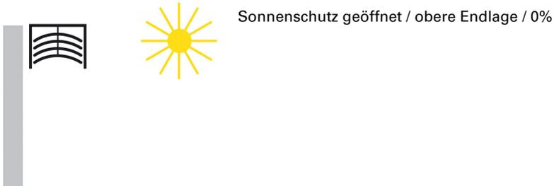
Soll die untere Endlage angefahren werden, so wird dies dem Jalousieaktor als Sonnenschutzstellung „100%“ vorgegeben bzw. das Erreichen der unteren Endlage (d. h. Sonnenschutz vollständig geschlossen) von ihm über diesen Wert gemeldet. Wird eine Jalousie aus der oberen Endlage herab gefahren, so kippen die Lamellen zuerst in eine fast senkrechte Lage, und der Sonnenschutz fährt mit geschlossenen Lamellen bis in die untere Endlage.
