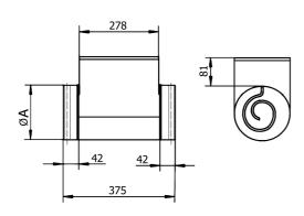
DRH 35-12 R: Keine Gummidichtung an den Anschlussstutzen
