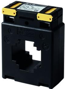
ECS Aufsteckstromwandler 200/5A KL.1 Sammelschiene 30x10, Rundleiter 28mm
