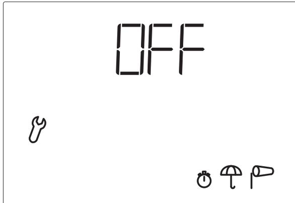
Wird Wind- oder Regenalarm ausgelöst, so wird die Beschattung eingefahren. Der Fahrbefehl für den angeschlossenen Antrieb endet entweder nach 4 Minuten oder er wird dauerhaft aufrechterhalten, so lange die Alarmmeldung vorliegt.
