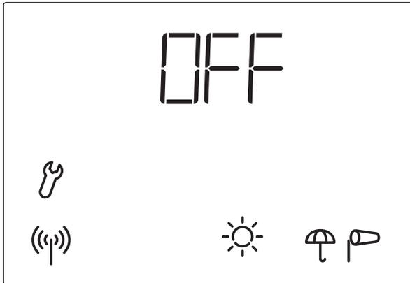
Belassen Sie diese Anzeige auf **OFF**, wenn die Solexa als normale Ein-Kanal-Steuerung verwendet wird. Die Funktion „Senden der Wetter- und Automatikdaten“ muss nur aktiviert werden, wenn die Solexa im Steuerungssystem XS mit Motorsteuergeräten (z. B. XS MSG2-AP) zusammenarbeiten soll.
