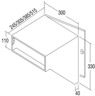
**RENZ Großraumkasten f. 1tlg. Frontplatten 245mm tief, Entnahmetür RAL 9007**
