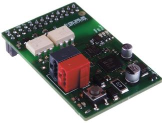
**WEINZIERL KNX Platine BAOS 838 kBerr 1000 Datenpunkte Entwicklermodul**
