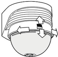
Der Erfassungsbereich kann durch Schwenken des Sensorkopfes horizontal (ca. ±45°) und vertikal (ca. ±15°) variiert werden.
