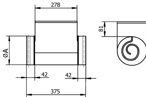
DRH 35-12 R: Keine Gummidichtung an den Anschlussstutzen
