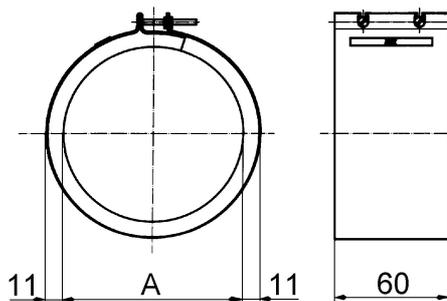
Darstellung im eingebauten Zustand, Lieferung erfolgt in gestreckter Form
