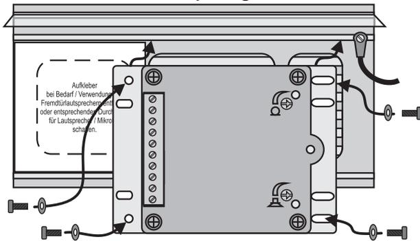
Montage am ELCOM Sprechgitter mit Hilfe der beigelegten Schrauben (M3x8).
