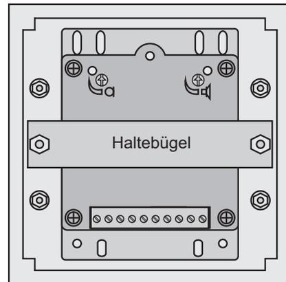
Montage mittels Haltebügel
