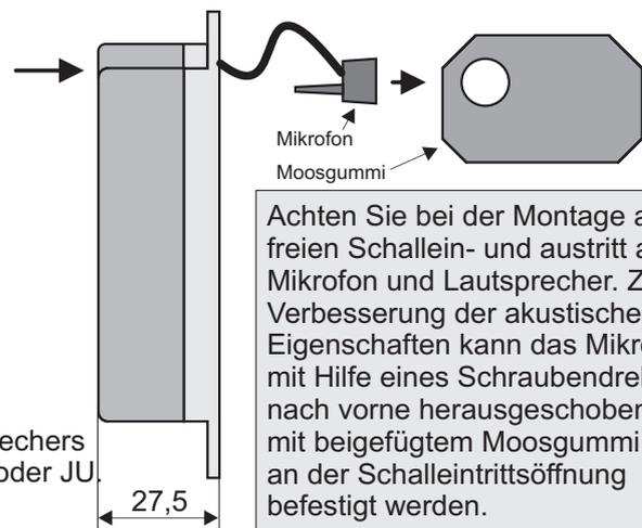
Achten Sie bei der Montage auf freien Schallein- und austritt an Mikrofon und Lautsprecher. Zur Verbesserung der akustischen Eigenschaften kann das Mikrofon mit Hilfe eines Schraubendrehers nach vorne herausgeschoben, und mit beigelegtem Moosgummi direkt an der Schalleintrittsöffnung befestigt werden.
