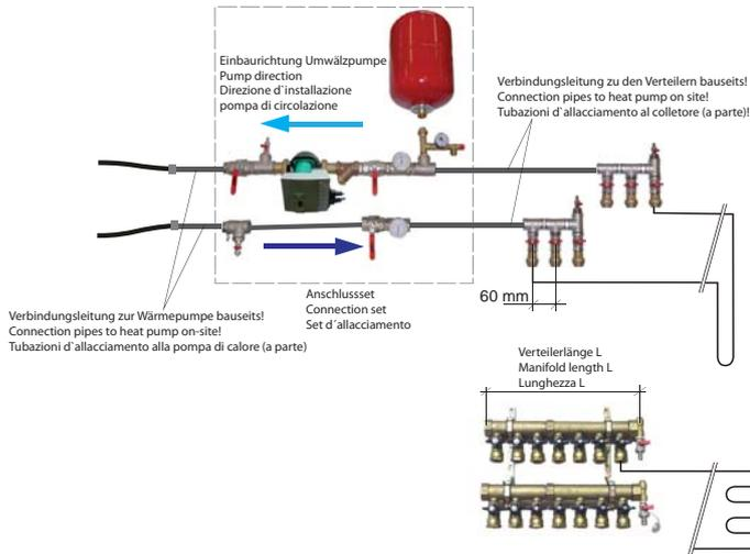
**Bei der Umwälzpumpe darf der Elektro-Klemmkasten nicht nach unten stehen! Der Pumpenkopf (Motor) darf nicht isoliert werden!**
