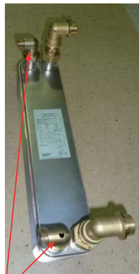
Fühler entfernen und in den Sicherheitswärmetauscher einbauen (Grundwasserseitig).
