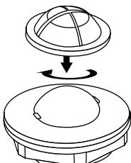
Falls der Erfassungsbereich zu groß ist oder Bereiche abdeckt, welche nicht überwacht werden sollen, kann mit der beiliegenden Abdecklamelle der Bereich nach Bedarf reduziert bzw. eingeschränkt werden.
