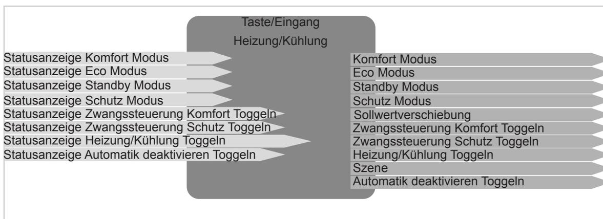
Bild 7: Ein-/Ausgangssignale Funktion Heizung/Kühlung
