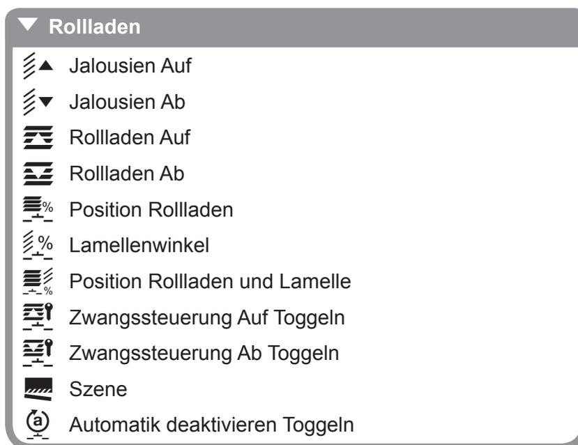
Bild 33: Funktionsübersicht **Rollläden**
