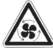
Après l'arrêt du ventilateur, le rotor continue de fonctionner pendant quelques instants par inertie. Ne pas introduire la main, pour éviter tout risque de blessures.
