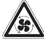
Nach dem Abschalten des Ventilators läuft das Laufrad noch einige Zeit nach. Nicht hineingelangen, da sonst Verletzungsgefahr besteht.
